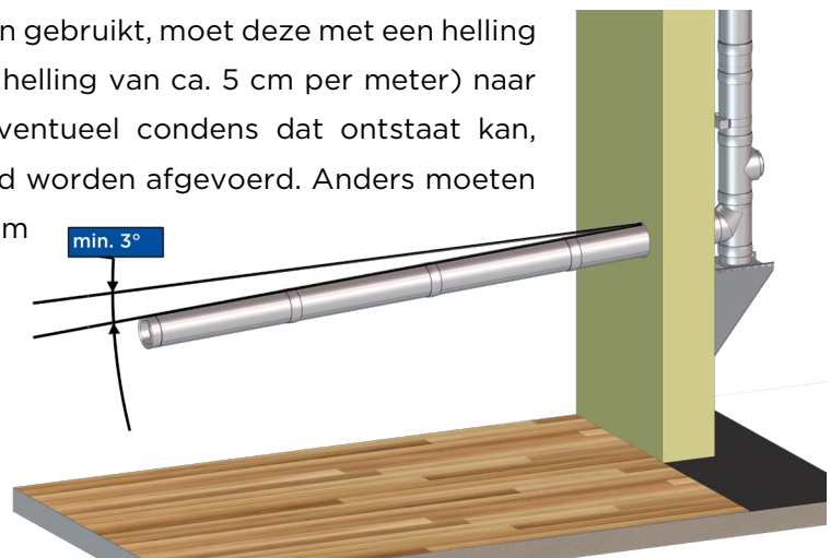
Bild 6-1: Notwendiges Gefälle (feuchte Betriebsweise)
