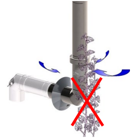
Abb. 5 Verbrennungsluft-Ansaugung frei halten
